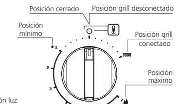
Para encender el horno mediante el encendido electrónico oprima (\*1) y gire la perilla del termostato (figura 14) en sentido antihorario hasta la posición máximo #7. Pulse esta perilla firmemente para accionar el dispositivo de seguridad (\*2) y la hornalla se encenderá automáticamente. Mantenga la perilla presionada durante 10 a 15 segundos (\*3). Al soltarla compruebe si el quemador permanece encendido (\*4).
