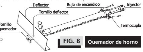
**FIG. 8 Quemador de horno**
